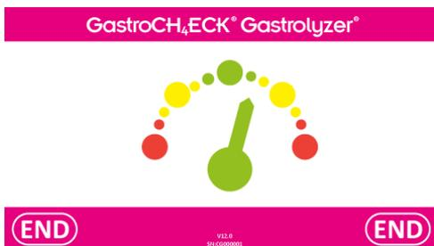
La flecha cambiará de color cuando el nivel de O<sub>2</sub> en la muestra de aliento se reduzca al objetivo del 15%, momento en el que se volverá verde y la prueba se detendrá automáticamente después de 3 segundos.
