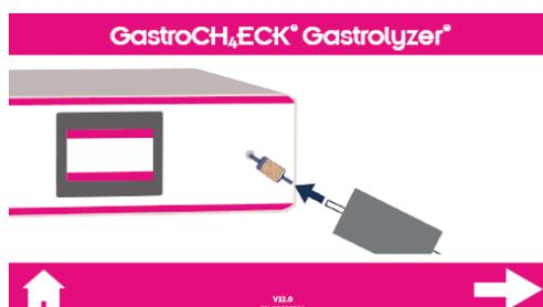
El dispositivo ilustrará entonces para colocar la bolsa de aliento. Asegúrese de retirar con cuidado el tapón azul en un solo extremo y coloque la bolsa en el filtro de humedad, luego abra la pinza en ese extremo solo para preservar la muestra.
