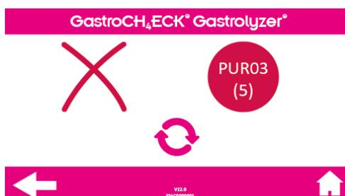
Error de lectura del sensor de CH<sub>4</sub>: verifique que no haya gas fluyendo a través del dispositivo. Si se estaba usando gas, espere 5 minutos antes de intentar una nueva prueba y luego presione el botón Reintentar. Si el error se produce más de 3 veces, reinicie la unidad. Si el fallo persiste, póngase en contacto con Bedfont® o con su distribuidor para obtener asistencia.
