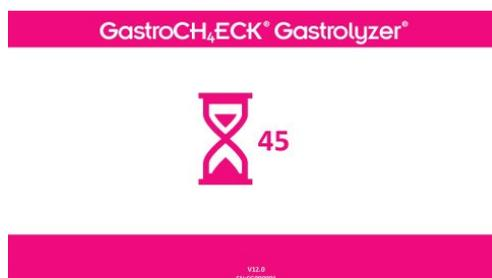
Una vez en cero, el muestreo de la bolsa de respiración comenzará automáticamente; asegúrese de que la abrazadera esté abierta. En este punto, el dispositivo no necesita más intervención hasta que se registra una lectura.
