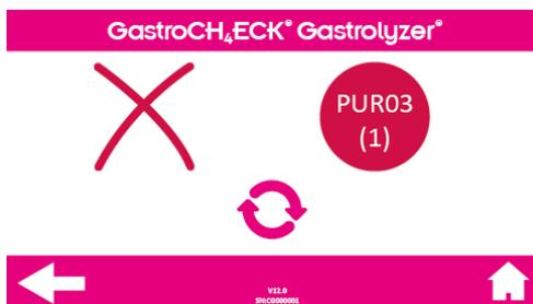
Error de conectividad del sensor CH<sub>4</sub>: presione el botón reintentar. Si el error se produce más de 3 veces, reinicie la unidad. Si el fallo persiste, póngase en contacto con Bedfont® o con su distribuidor para obtener asistencia.
