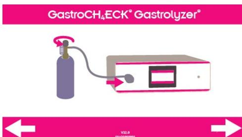
Conecte el CaliAdapter a monitorear a través de la línea de muestra y abra el recipiente de gas. Presiona la flecha para comenzar la calibración.
