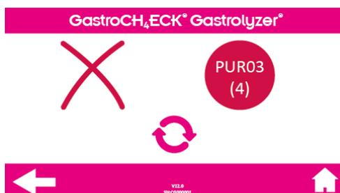
Falla del sensor CH<sub>4</sub>: Presione el botón de reintento. Si el error se produce más de 3 veces, reinicie la unidad. Si el fallo persiste, póngase en contacto con Bedfont® o con su distribuidor para obtener asistencia.
