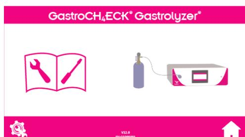
Abra el menú de configuración e inicie el proceso de calibración seleccionando el icono de calibración.
