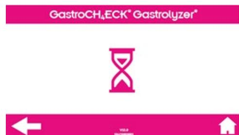
Se mostrará un temporizador en la pantalla, mientras que los sensores se ponen a cero. Esto puede llevar hasta 75 segundos si se acaba de realizar una prueba.
