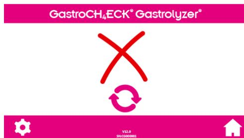
Calibración fallida: compruebe que el tubo de gas de calibración esté conectado al puerto de muestreo de respiración.
