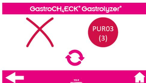
Error del sensor de CH<sub>4</sub>: verifique que la temperatura ambiente esté dentro del rango y que la unidad esté enchufada correctamente. Luego presione el botón de reintento. Si el error se produce más de 3 veces, reinicie la unidad. Si el fallo persiste, póngase en contacto con Bedfont® o con su distribuidor para obtener asistencia.
