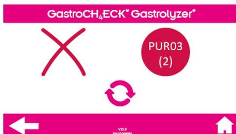
CH4 Sensor Check Check Sum / End Char error: presione el botón de reintento. Si el error se produce más de 3 veces, reinicie la unidad. Si el fallo persiste, póngase en contacto con Bedfont® o con su distribuidor para obtener asistencia.
