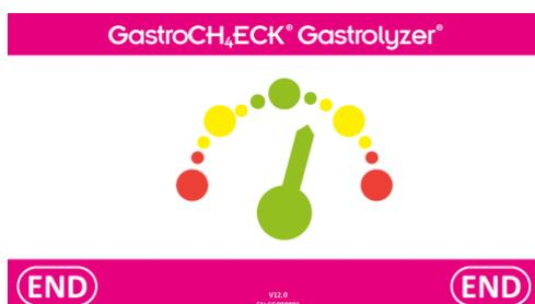
La freccia cambia colore quando il livello di O<sub>2</sub> nel campione respiratorio raggiunge l'obiettivo del 15%, commutando a luce verde: dopo 3 secondi il test si arresta automaticamente.
