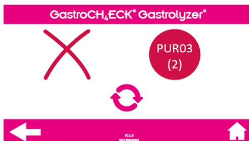
Errore check sum/car. finale del sensore CH<sub>4</sub>: premere il pulsante Riprova. Se l'errore si ripete più di 3 volte, riavviare il dispositivo. Se il problema persiste, richiedere assistenza a Bedfont® o a un suo distributore.
