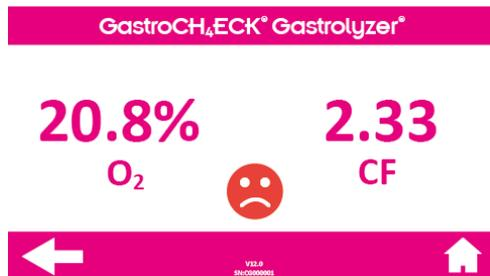
Sarà visualizzata la concentrazione di O<sub>2</sub> in percentuale con il fattore di correzione applicato alla lettura, qualora richiesto. Un indicatore visivo aiuterà nell'interpretazione del risultato:
