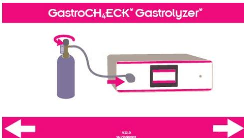
Collegare l'adattatore di calibrazione CaliAdapter al monitor tramite il tubo di campionamento, quindi aprire la bombola del gas. Per avviare la calibrazione, premere la freccia.
