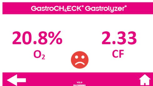
Sarà visualizzata la concentrazione di O<sub>2</sub> in percentuale con il fattore di correzione applicato alla lettura, qualora richiesto. Un indicatore visivo aiuterà nell'interpretazione del risultato:
