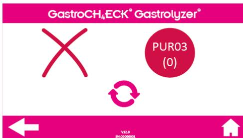
Errore di sincronizzazione del sensore CH<sub>4</sub>: premere il pulsante Riprova. Se l'errore si ripete più di 3 volte, riavviare il dispositivo. Se il problema persiste, richiedere assistenza a Bedfont® o a un suo distributore.
