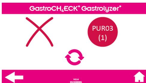
Errore di connettività del sensore CH<sub>4</sub>: premere il pulsante Riprova. Se l'errore si ripete più di 3 volte, riavviare il dispositivo. Se il problema persiste, richiedere assistenza a Bedfont® o a un suo distributore.
