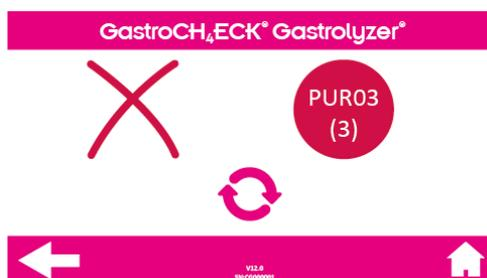
Erro no sensor de CH<sub>4</sub>: Verifique se a temperatura ambiente está dentro da faixa recomendada e se a unidade está conectada corretamente. A seguir, pressione o botão de repetição. Se o erro ocorrer mais de 3 vezes, por favor, reinicie a unidade. Se a falha persistir, entre em contato com a Bedfont® ou com o seu distribuidor para obter suporte.
