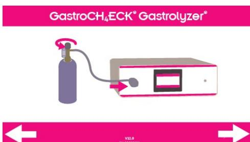
Conecte o CaliAdapter ao monitor através da linha de amostra e abra o cilindro de gás. Pressione a seta para iniciar a calibração.
