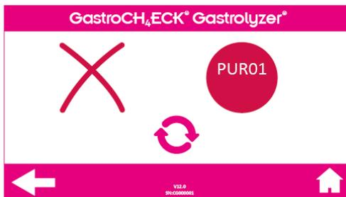
Falha no zeramento do sensor de H<sub>2</sub>: Faça o teste respiratório ou teste de saco coletor novamente. Se a falha persistir, entre em contato com a Bedfont® ou com o seu distribuidor para obter suporte.
