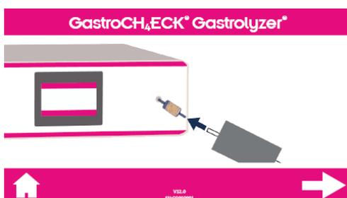
O dispositivo irá então ilustrar como conectar o saco coletor de ar expirado. Certifique-se de remover cuidadosamente o plugue azul somente de uma extremidade e conecte o saco ao filtro de umidade, em seguida abra o clipe somente nessa extremidade para preservar a amostra.
