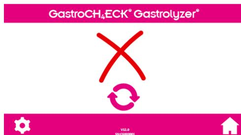
Falha na calibração: Verificar se a tubulação de gás de calibração está conectada à porta de amostragem de respiração.
