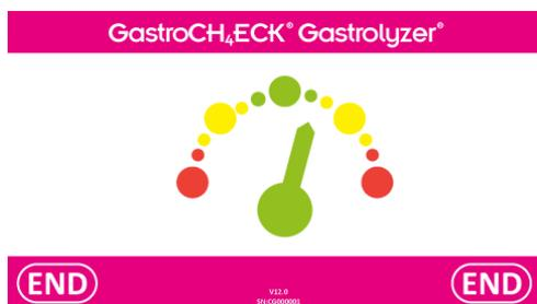
A seta mudará de cor à medida que o nível de  $O_2$  na amostra de respiração reduzir em 15 % do alvo, quando ficará verde e o teste será interrompido automaticamente após 3 segundos.
