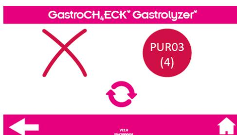
Falha do sensor de CH<sub>4</sub>: Pressione o botão de repetição. Se o erro ocorrer mais de 3 vezes, por favor, reinicie a unidade. Se a falha persistir, entre em contato com a Bedfont® ou com o seu distribuidor para obter suporte.
