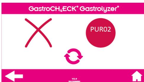
Falha no zeramento do sensor de O<sub>2</sub>: Faça o teste respiratório ou teste de saco coletor novamente. Se a falha persistir, entre em contato com a Bedfont® ou com o seu distribuidor para obter suporte.
