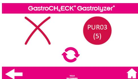
Erro na leitura do sensor de CH<sub>4</sub>: Verifique se não há gás fluindo pelo dispositivo. Se o gás estava sendo usado, por favor, aguarde 5 minutos antes de tentar um novo teste e pressione o botão de repetição. Se o erro ocorrer mais de 3 vezes, por favor, reinicie a unidade. Se a falha persistir, entre em contato com a Bedfont® ou com o seu distribuidor para obter suporte.
