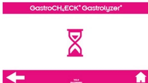
Uma ampulheta será exibida na tela, enquanto os sensores são zerados. Isso poderá levar até 75 segundos se um teste tiver acabado de ser realizado.
