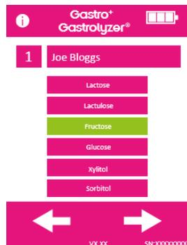
Wählen Sie das Protokoll aus, indem Sie den Protokollnamen drücken, zum Beispiel „Lactose“. Wenn das Protokoll ausgewählt wird, wechselt seine Farbe auf grün. Zum Bearbeiten der Zeitangaben für das Protokoll siehe den Abschnitt „Testprotokolle bearbeiten“ in dieser Bedienungsanleitung.
