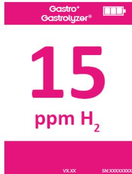
Der ppm-Wert steigt an und bleibt auf dem höchsten Wert. Wenn dieser Wert 5 Sekunden lang nicht mehr angestiegen ist, kann das Testergebnis aufgezeichnet und der Test gestoppt werden.
