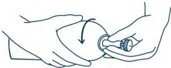
Schrauben Sie das Feinregulierventil und die Durchflussmesser-Baugruppe auf den Gasbehälter. Das funktioniert am besten, wenn man den Gasbehälter in das Ventil schraubt.
