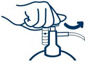
Lassen Sie das Gas für die gesamte Dauer des Tests durch das Gerät strömen und überwachen Sie dabei die Durchflussmenge.
