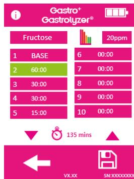
Sie können bis zu 10 Zeitintervalle auswählen, indem Sie das Feld mit dem jeweiligen Intervall drücken und den Wert mit dem Pfeil nach oben oder unten erhöhen oder verringern.
