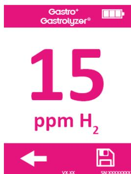
En cas d'échec du test, quelle qu'en soit la raison, relancez le test en appuyant sur la flèche Retour de l'écran des résultats. Cette action efface le résultat précédent.
