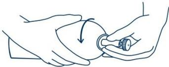
Vissez la valve de réglages fins et le débitmètre sur la bouteille de gaz. Le meilleur moyen consiste à visser la bouteille de gaz sur la valve.
