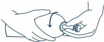
Aparafuse a válvula de controle fina e o conjunto do indicador de fluxo para a recipiente de gás. É possível fazer isso melhor aparafusando o recipiente de gás na válvula.
