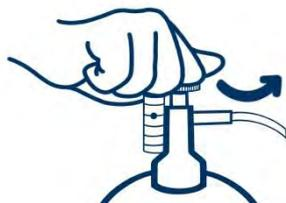
Deixe o gás fluir pelo instrumento durante a duração do teste, monitorando novamente o fluxo.
