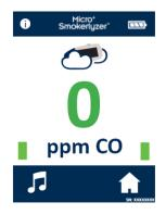
Der Micro<sup>+™</sup> wird dann eine Echtzeitmessung der Umgebungsluft durchführen. Um den Test zu stoppen, drücken Sie das HOME-symbol.
