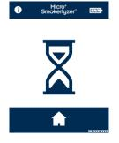
Wenn dies erfolgreich abgeschlossen wurde, wird das Gerät auf Null gesetzt; geben Sie jetzt kein Gas zu.
