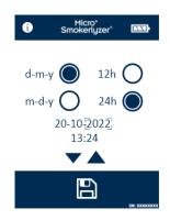
Wählen Sie entweder **T-M-J** (d-m-y) oder **M-T-J** (m-d-y) als Datumsformat und **12 h** oder **24 h** als Uhrzeitformat aus.
