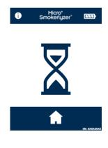
Das Gerät kann diesen Bildschirm einblenden, wenn der Sensor auf Null gestellt wird.
