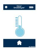
Wenn die Temperatur des Gerät zu niedrig ist für die Kalibrierung, wird das blaue Thermometer angezeigt. Versuchen Sie es später noch mal, wenn sich das Gerät erwärmt hat – wenn das Problem weiterhin auftritt, wenden Sie sich an Bedfont® oder den Fachhändler vor Ort.
