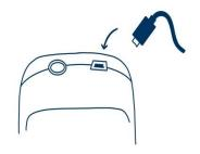
Stecken Sie ein Ende des Verbindungskabels in die USB-Buchse an der Oberseite des Smokerlyzer® ein.
