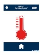
Wenn die Temperatur des Gerät zu hoch ist für die Kalibrierung, wird das rote Thermometer angezeigt. Versuchen Sie es später noch mal, wenn sich das Gerät erwärmt hat – wenn das Problem weiterhin auftritt, wenden Sie sich an Bedfont® oder den Fachhändler vor Ort.
