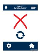
Wenn die Kalibrierung fehlgeschlagen ist, wird dies durch das Symbol mit dem roten X angezeigt. Drücken Sie das Symbol mit den drehenden Pfeilen, um die Kalibrierung erneut durchzuführen. Wenn das Problem weiterhin auftritt, siehe den Abschnitt "Fehlerbehebung" oder rufen Sie der Bedfont® Fachhändler vor Ort an.
