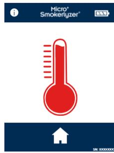
Si la temperatura del dispositivo es demasiado alta para realizar la calibración, se mostrará el termómetro rojo en la pantalla. Una vez que la unidad haya disminuido la temperatura, intentar nuevamente. Si el problema persiste, comunicarse con Bedfont® o el proveedor local.
