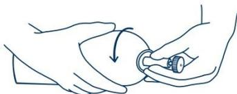
2. Enroscar el ensamblaje de la válvula de ajuste fino y el indicador de flujo en el tubo de gas. Lo ideal es enroscar el tubo de gas en la válvula.
