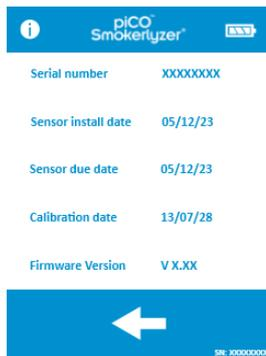
La pantalla de información muestra información sobre el dispositivo y el sensor.
