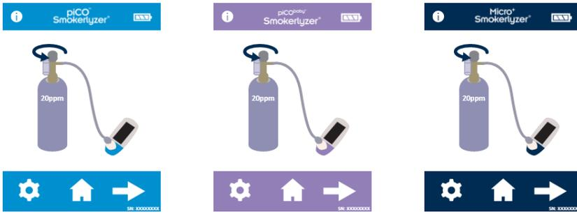
Inserte un D-piece™ en el dispositivo y abra el gas. Presiona la flecha para continuar.
