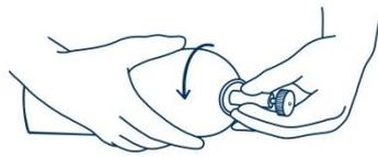
Aparafuse o conjunto da válvula de controlo fino e do indicador de fluxo à lata de gás. A melhor forma de o fazer é aparafusar a lata de gás à válvula.
