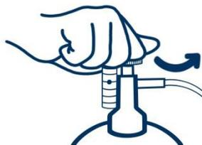
6. Deixe o gás fluir através do instrumento durante todo o teste, monitorizando novamente o caudal.
