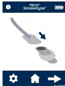
Fixe uma D-piece™ ao adaptador de calibração. Prima a seta para continuar o processo de calibração.
