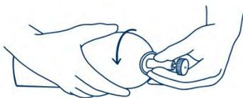
2. Aparafuse o conjunto da válvula de controlo fino e do indicador de fluxo à lata de gás. A melhor forma de o fazer é aparafusar a lata de gás à válvula.
