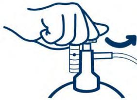
Deixe o gás fluir através do instrumento durante todo o teste, monitorizando novamente o caudal.
